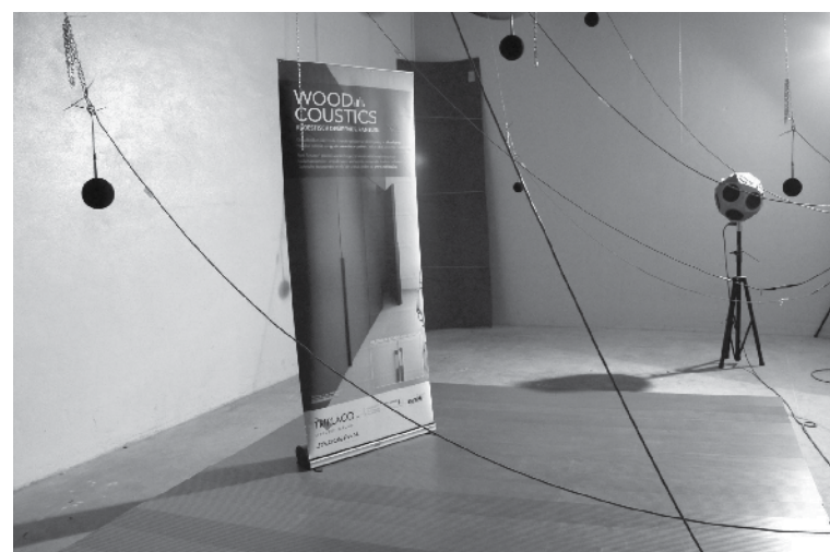
Test en labo – EN ISO 354:2003
