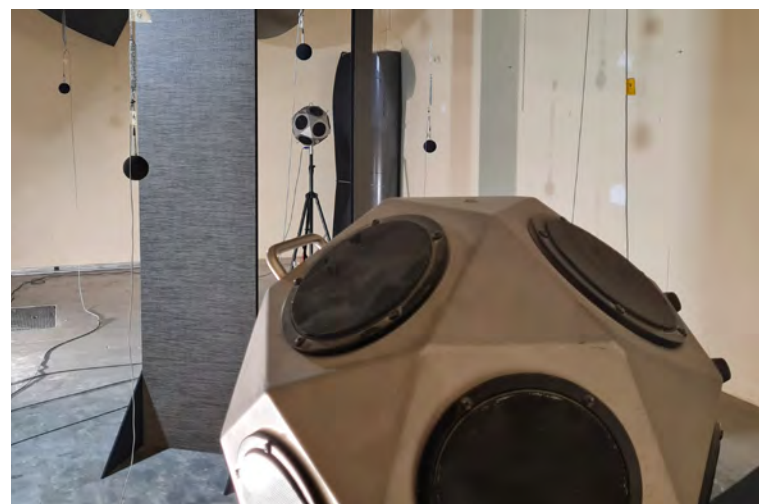
Labo testopstelling - EN ISO 354:2003
